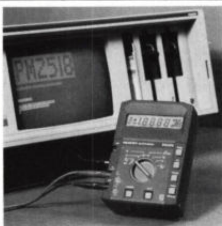
Afb. 4. De I 2 C-bus wordt ook gebruikt voor testen en kalibreren; hier is de PM2518X afgebeeld in een opstelling met de micro computer P2000C.
